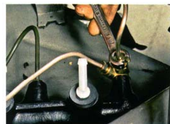
33. Im nächsten Arbeitgang befestigt man die Bremsleitungen für die beiden Vorderräder an dem Y-Verteiler mit einem offenen 11er Ringschlüssel.
