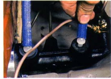
36. Auf die beiden Kniestücke schiebt man den Nachlaufschlauch (und nur den, denn der ist bremsflüssigkeitsresistent) und befestigt die zwei ...
