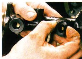
26. Zunächst entfernt man die am Hauptbremszylinder verwendeten Dichtungsstopfen und ersetzt sie gegen die im Adapter-Kit ...
