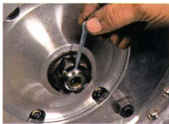
70. Jetzt die Handbremse im Innenraum feineinstellen, die Kronenmutter mit 350 Nm festziehen und mit ...
