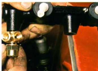
29. Darauf folgt die Montage des Y-Verteilers der mittels einer Hohl-schraube am (in fahrtrichtung vorderen) Abgang befestigt wird.
