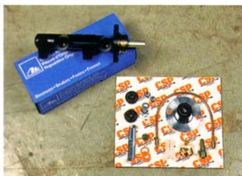
25. Hier sieht man den HBZ mit 20,64 mm Kolbendurchmesser plus das notwendige Adapter-Kit von Custom & Speed Parts.
