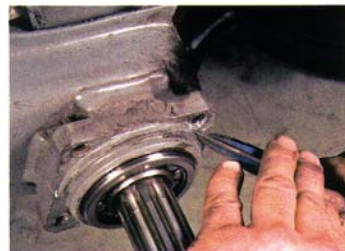
44. Wie bei den vorderen Achsschenkeln muss auch das Achsrohr hinten penibel gesäubert und geglättet werden.
