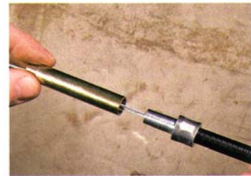
42. Jetzt steckt man über das neue Seil zunächst das lange Distanzstück (609722002) und dann die alte Bowdenzughülle.
