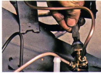
35. ... Zwei- oder Drei-Pol-Schalter handelt. Bleibt nur noch die elektrische Verbindung durch Aufstecken der Kabel wiederherzustellen.
