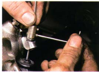
68. Nun wird auf das Seilende das Klemmstück aufgesetzt und mit den zwei Gewindestiften fixiert. Die endgültige Position sollte man ...
