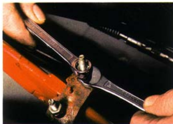
40. Konter- und Einstellmutter am Handbremsgriff lösen und entfernen. Bremsseile von unten aus den Führungen herausziehen.
