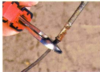
41. Als nächstes kappt man ein Ende des alten Bremsseils mit einem Seitenschneider und zieht die Bowdenzughülle ab.
