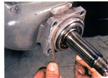
45. Groben Schmutz oder Farbe mit Drahtbürste oder Teppichmesser entfernen, zum Schluss mit Schleifpapier drüber fahren.
