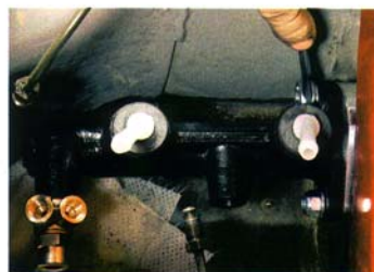
32. ... innen durchgeführt (bitte anpassen, dass die Hülsen im Rahmen nicht herunterfallen!) und darauf der HBZ mit 13er Muttern befestigt werden.
