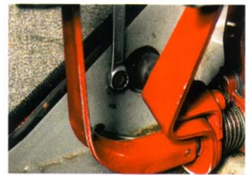
24. ... vorsichtig losgeschraubt werden (Zum besseren Arbeiten Tank heraus nehmen). Dann innen die beiden Schrauben lösen und HBZ abziehen.
