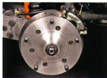
71. ... neuen Splinten sichern. Nun die Bremse entlüften, dabei fängt man mit dem am weitesten vom HBZ ...
