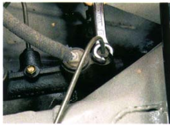
23. Falls noch kein passender Hauptbremszylinder (HBZ) vorhanden ist, müssen nun die Leitungen mit einem offenen 11er Ringschlüssel ...
