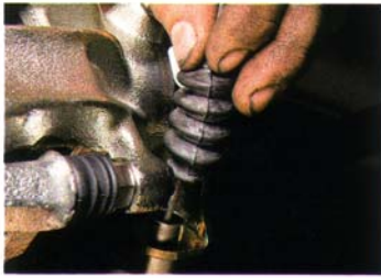
67. Das freie Ende des Handbremsseils steckt man in den Halter am Sattel und stülpt den kleinen Faltenbalg darüber.
