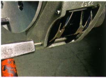
22. ... mitgelieferten Haltestifte bitte darauf achten, dass die Federn richtig sitzen, so wie es hier auf dem Bild deutlich zu sehen ist.
