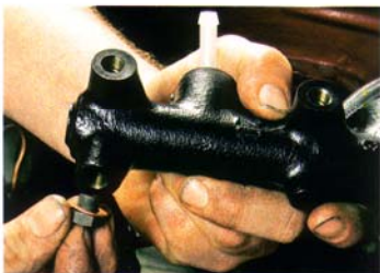
28. Der nach unten zeigende Abgang vom Hauptbremszylinder wird von der beiliegenden Schraube samt Kupferferring verschlossen.
