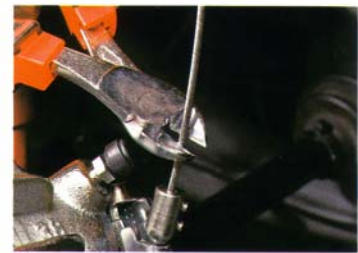
69. ... aber erst nach ein paar Betätigungen der Handbremse festlegen. Dann die Stifte mit Schraubensicherung einstreichen und Seil kappen.
