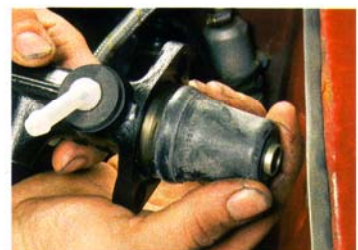
30. Da moderne HBZ normaler weise an Servobehälter montiert werden, haben sie keine Staubschutzkappe. CSP legt eine spezielle Kappe ...
